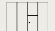
Con portina pedonale senza soglia inferiore With pedestrian door without lower guides
