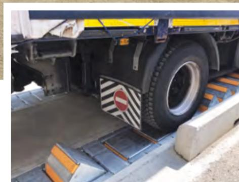
I cunei si sollevano in modo da bloccare le ruote, senza interferire o urtare i parafranghi e le attrezzature dei camion.
